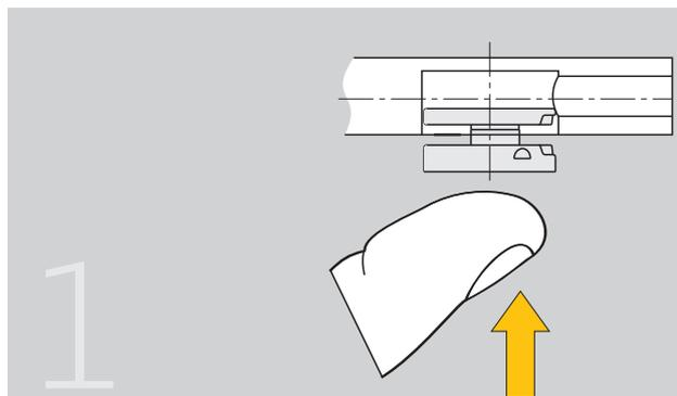
Introducir manualmente el ensamblaje excéntrica de Espiral en el mecanizado de la balda o tablero.
