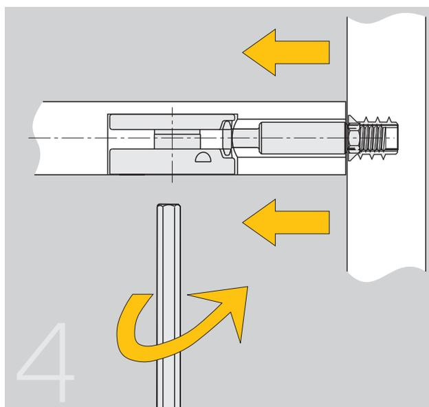
Al efectuar el giro de la excéntrica, el perno se desplaza hacia la excéntrica, y conseguimos unir el lateral y el ensamblaje. Con ello se consigue un fuerte y eficaz amarre.
