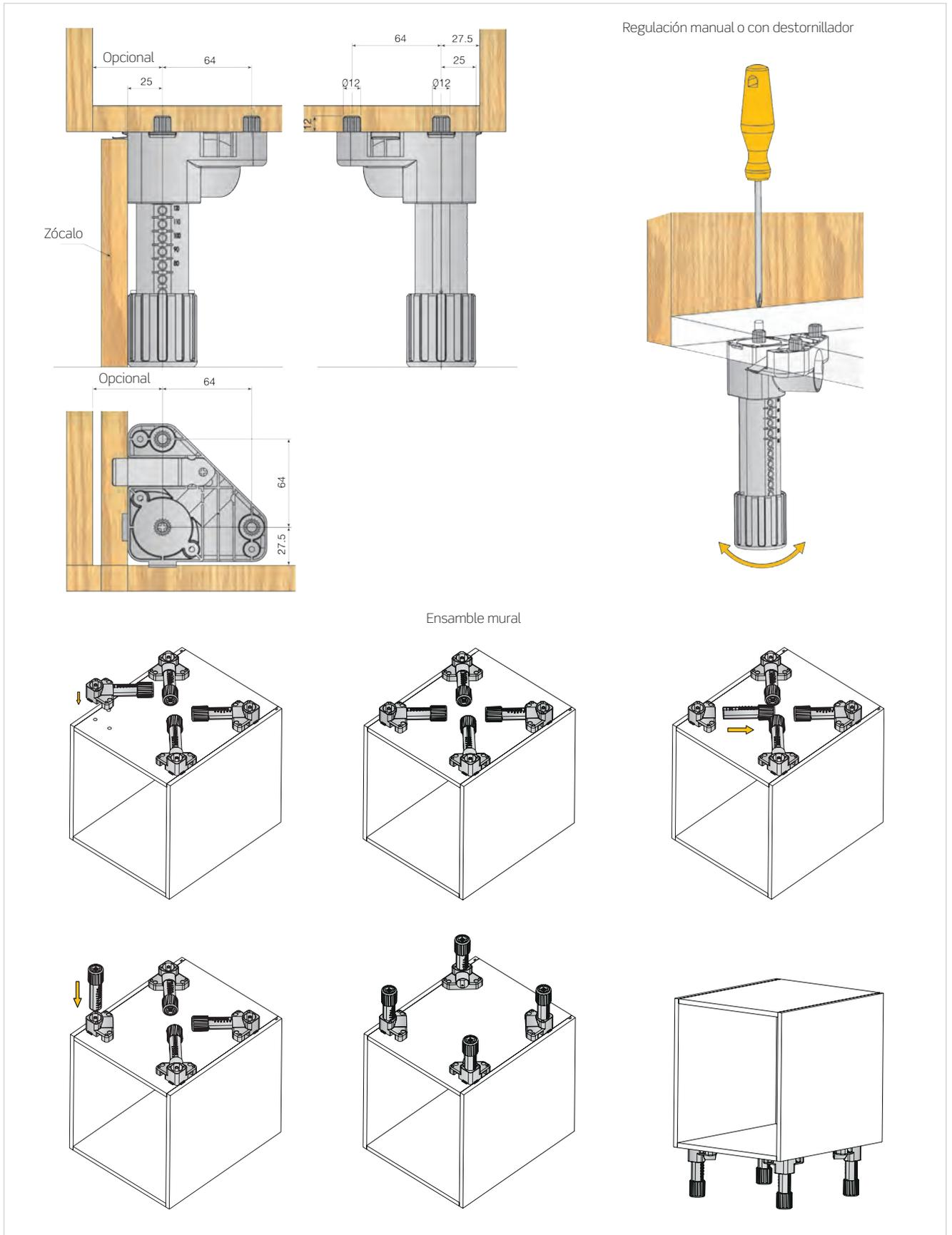
Patas montadas: distribución de las patas según módulo
