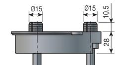
Base de fijación montaje por tirafondos.
