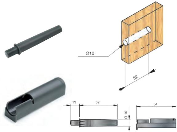
La base dispone de una pestaña para el posicionamiento en el canto del mueble. Fijar el tirafondo de Ø3x12 y a continuación introducir frontalmente el amortiguador.
