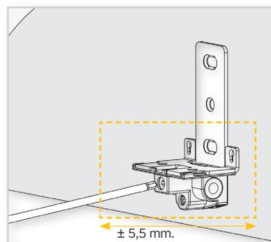
El módulo no necesita de ningún mecanizado previo a la fijación del mismo en el soporte inferior.
