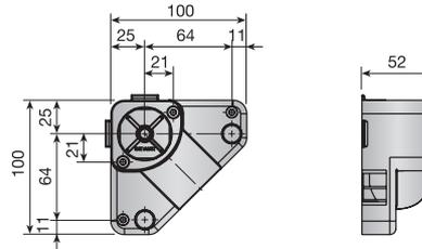
Embase de fixation 3 pivots Ø12 montage à pression/à visser.
