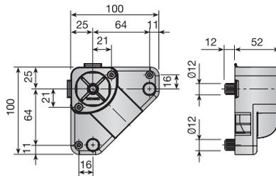
Embase de fixation 1 pivot Ø12 montage à pression/à visser.
