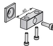
Assemblage de 40 mm. pour support d'étagère, à assembler à l'angle.
