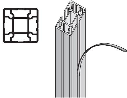
Pour libérer la rainure, il suffit d'arracher la bande protectrice en aluminium.
