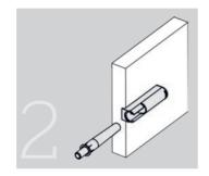
Le support est doté d'une languette pour le positionnement sur le chant du meuble. Fixer la vis de Ø3x12 puis introduire l'amortisseur de face.
