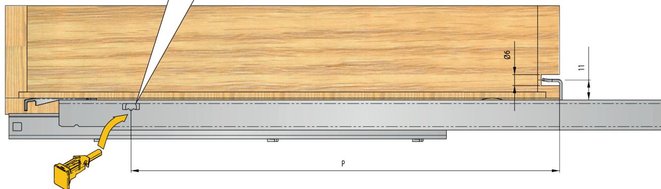
■ Chiusura soft + apertura inversa **IMPULSE** premontata. Fissaggio a clip
