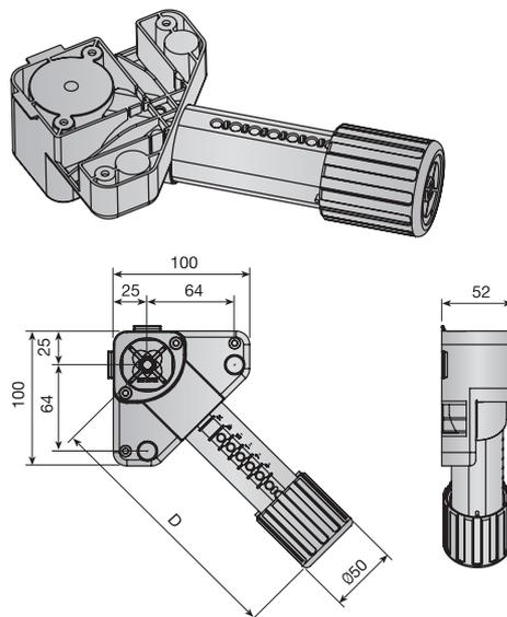
Confezione di piedini assemblati. Tre perni Ø 12. Montaggio a pressione/ a vite
