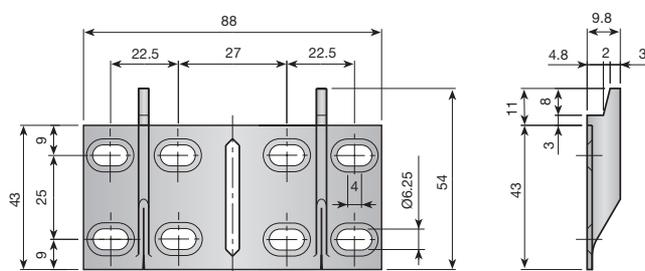
Piastra di fissaggio a muro
