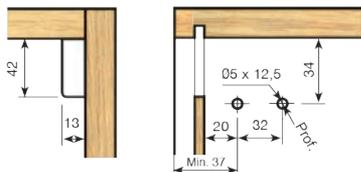
Attaccaglia con montaggio a pressione, con sistema anti-tilt per piastra
