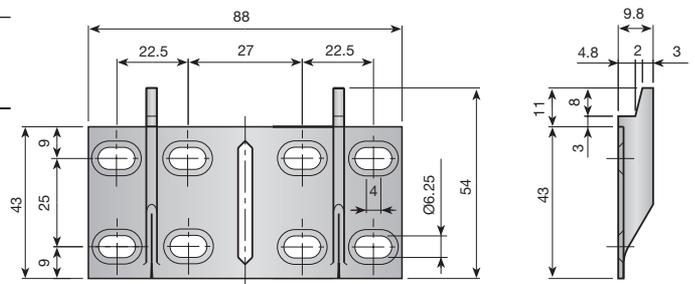
Piastra doppia per il montaggio a muro.
