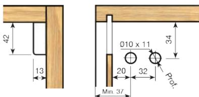
Attaccaglia con montaggio a viti, con sistema anti-tilt per piastra
